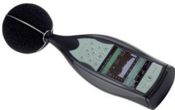
Fig.1 Fonometro mod. "B&K 2260" della Bruel & Kjaer
